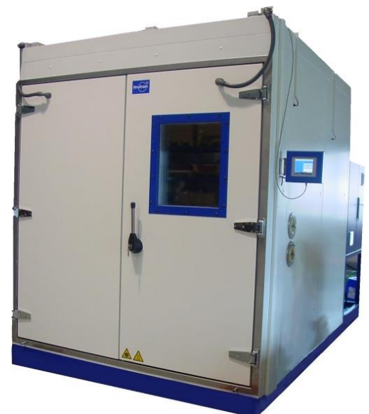
chambres climatique, 10m 3 -70 à 180°C / 10 à 98%hr avec simulation de sol
