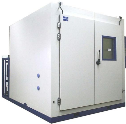
chambres climatique, 8m 3 -70 à 180°C / 10 à 98%hr
